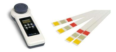
Alle im Versuch gemessenen Werte entsprechen den Vorgaben der EU-Richtlinien. Die pH-Werte wurden mit den Teststreifen im Bereich 7 bis 8 nachgewiesen, mit dem "PoolLab" wurden Werte zwischen 7,21 und 7,45 gemessen. Diese liegen im Bereich der EU-Vorgaben von 6,5 bis 9,5.
